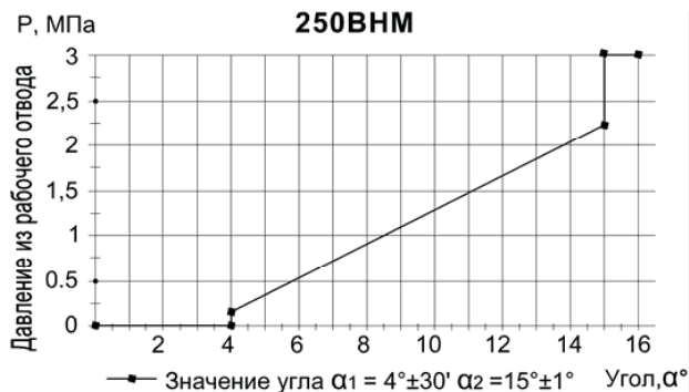
Рис.2 Зависимость редуцированного давления от угла поворота
